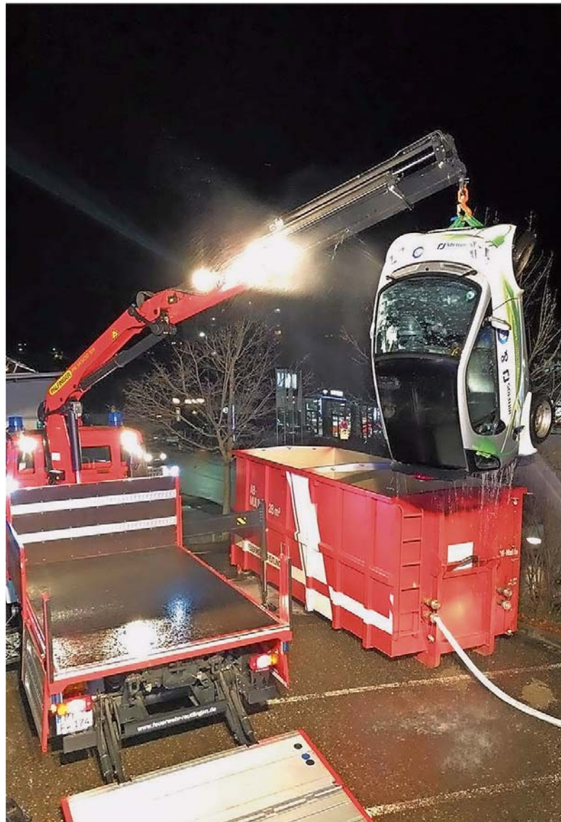
Wenn nur noch versenken hilft: Um den Brand eines E-Autos in den Griff zu bekommen, hob die Feuerwehr Reutlingen (Baden-Württemberg) einen Smart in einen mit Wasser gefüllten Abroll-Container. FOTO: FEUERWEHR REUTLINGEN
