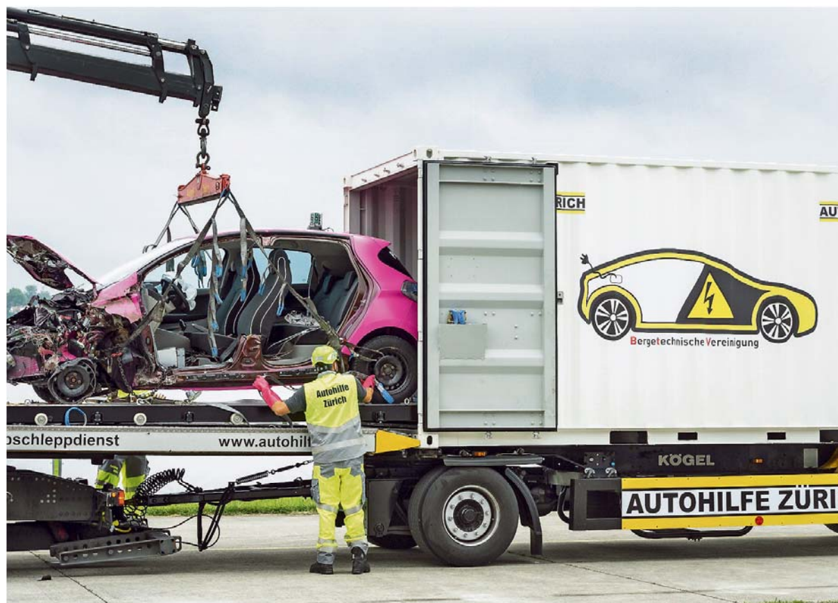
Ein Unfall mit einem Elektroauto ist besonders gefährlich. Das Leichtmetall Lithium in der Batterie ist extrem brennbar. Es kann sich noch Stunden später entzünden. Daher gibt es spezielle Container zum Abtransport solcher Unfallwagen.
