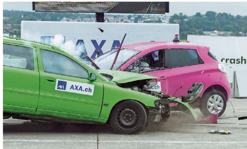
Prallt ein herkömmlicher Wagen wie in diesem Crashtest ein Volvo V70 (links) gegen ein Elektroauto wie den Renault Zoe, kann die beschädigte Batterie des E-Autos unkontrollierbar und kaum noch löschtbar in Flammen aufgehen.
